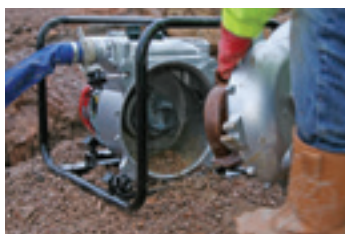
Odnímateľný kontrolný kryt umožňuje rýchly a jednoduchý prístup
